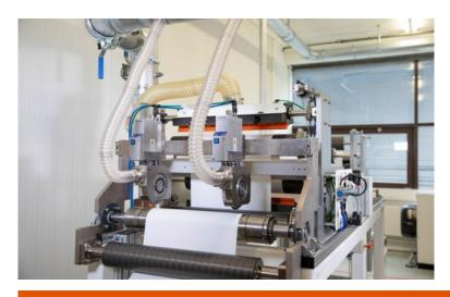
Um der gestiegenen Nachfrage nach Vorführungen und Kundenversuchen - Absaugung von Schnittstaub - gerecht zu werden, wurde die Versuchsanlage in unserem Kundenlabor mit 2 pneumatischen Dienes Messerhaltern und der Schnittstaubabsaugung SLITstream System von Hildebrand Technology ausgestattet.
