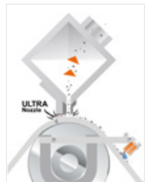
Funktionsprinzip Xstream ULTRA
